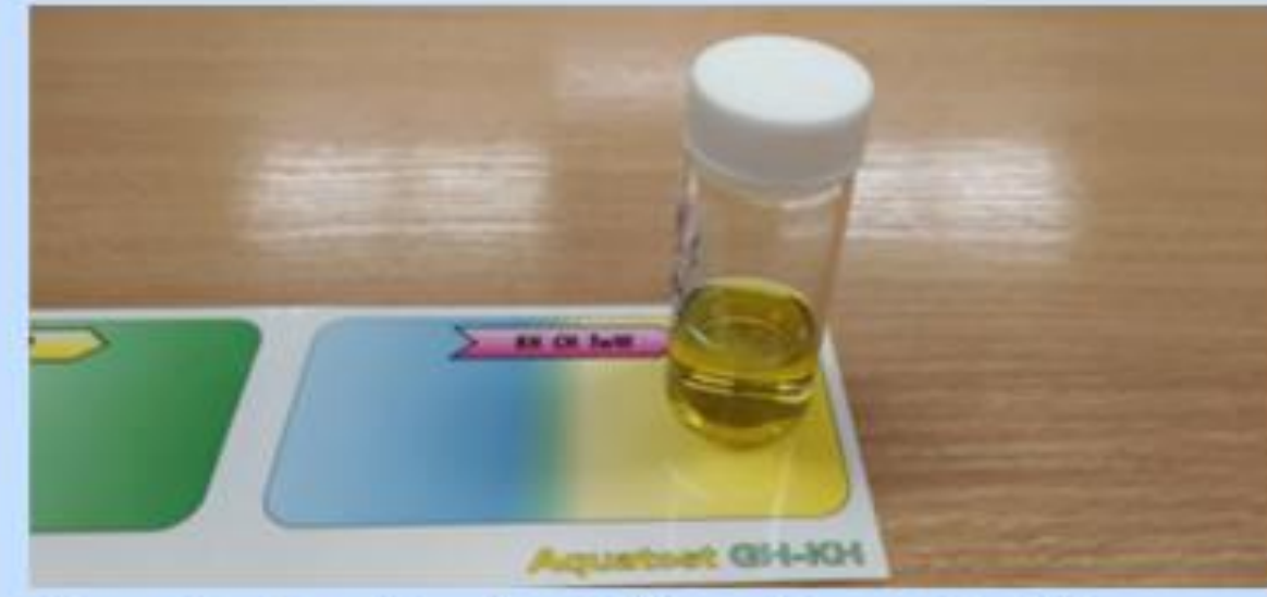
Ryc.2. Badanie KH - (twardość węglanowa - zawartość jonów wapnia i magnezu) - 18 kropli.
